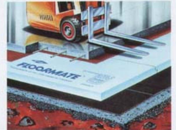
Şekil 20. Yük taşıyan teras çatı
